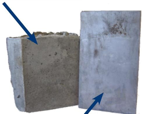
Banche de décoffrage initialement rouillée, dégraissée phosphatée avec CIM KO suivi d'un rinçage à l'eau et enduite après séchage avec huile de décoffrage CASTOFF
